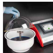
Prueba de colorante azul de metileno con tapa abovedada
